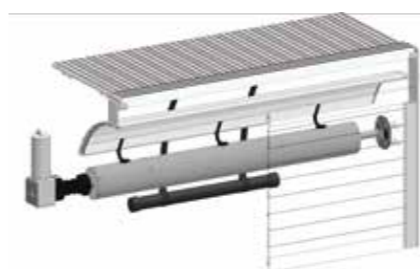
Sirius External med motoren i en vannrett kiste.
